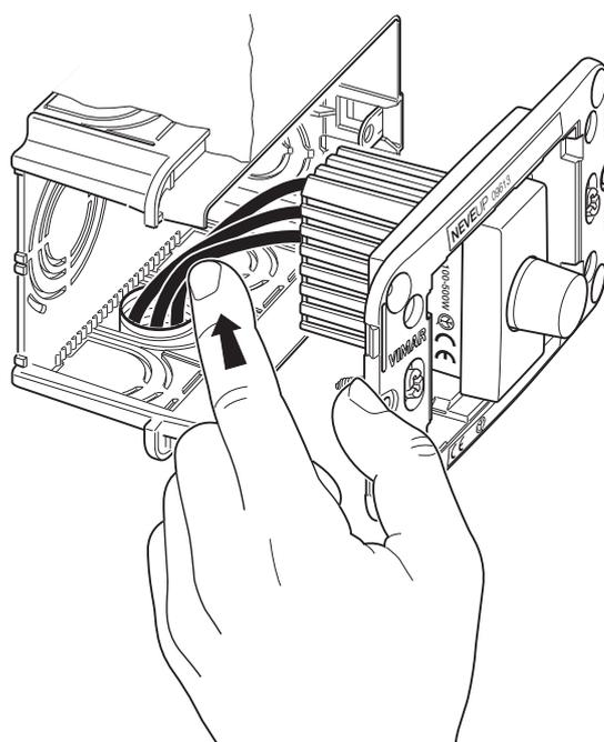
Spingere i conduttori di collegamento sul fondo della scatola onde evitare che i conduttori vadano a toccare il corpo del dimmer.
