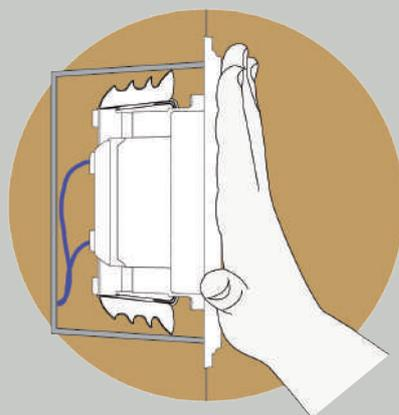
Зубцы сильно упираются в стенки и предотвращают выпадение механизма
