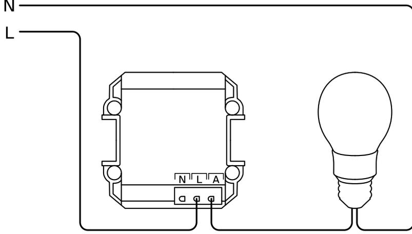
ДАТЧИК ДВИЖЕНИЯ, ВЫКЛЮЧЕНИЕ С ПОМОЩЬЮ ВЫКЛЮЧАТЕЛЯ
