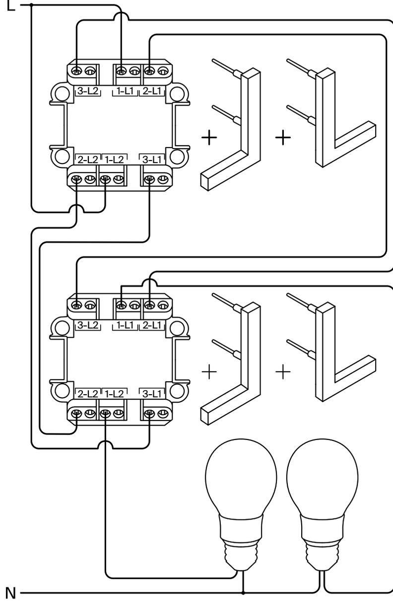
СВЕТОРЕГУЛЯТОР С НАГРУЗКОЙ И ПРОХОДНЫМ ПЕРЕКЛЮЧАТЕЛЕМ ↗
