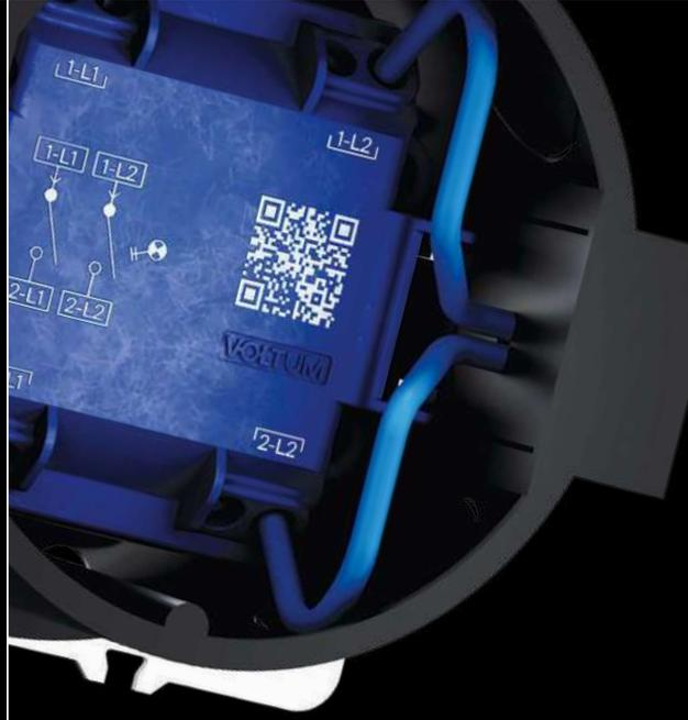
Вывод проводов подключения расположен под углом к задней поверхности механизма, что уменьшает его размер и упрощает монтаж.
