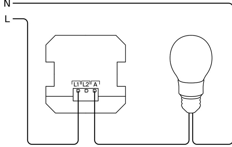
ДАТЧИК ДВИЖЕНИЯ, ВЫКЛЮЧЕНИЕ С ПОМОЩЬЮ ВЫКЛЮЧАТЕЛЯ
