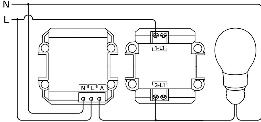
ДАТЧИК ДВИЖЕНИЯ, УПРАВЛЕНИЕ НАГРУЗКОЙ С 1 МЕСТА
